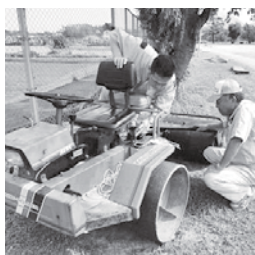
コートローラーの修理
