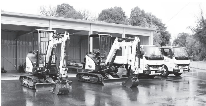
配備された油圧ショベルと3tダンプ
